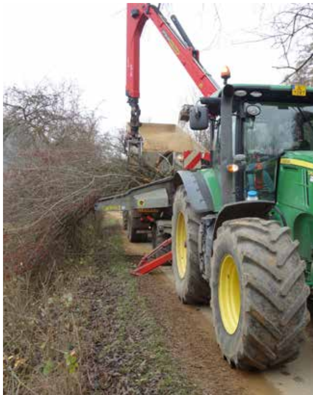
Broyage des déchets de taille. Celui-ci sera ensuite utilisé comme paillage ou valorisé thermiquement.
