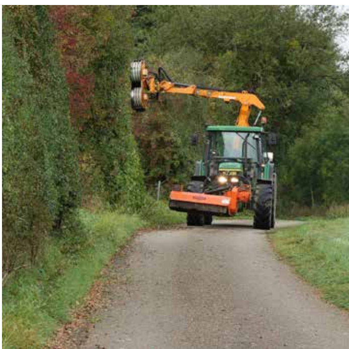
La tête de coupe est attelée à un tracteur et peut effectuer trois opérations en même temps, notamment taille, broyage, déblaiement.
